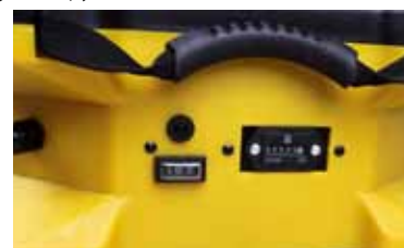
Панель управления CDX 20, таймер наработки часов
