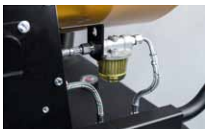
Устройство предварительного нагрева топлива (опция), топливный фильтр снаружи
